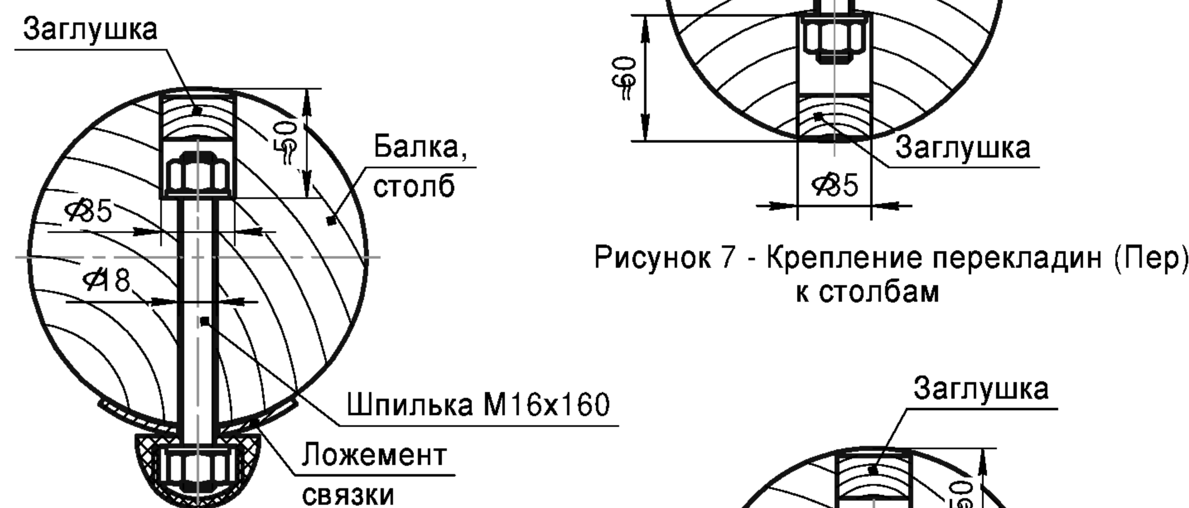
Рисунок 6 - Крепление балки и столбов к связкам
