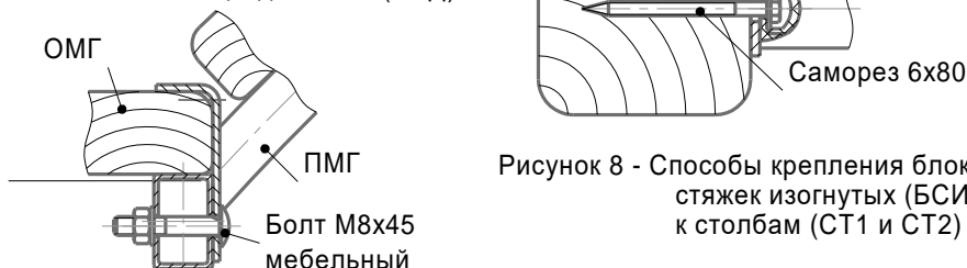
Рисунок 9 - Крепление пролёта мостика горбатого (ПМГ) к его опорам (ОМГ)
