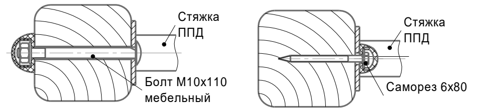
Рисунок 21 - Способы крепления перехода подвесного дугового (ППД) к столбам
